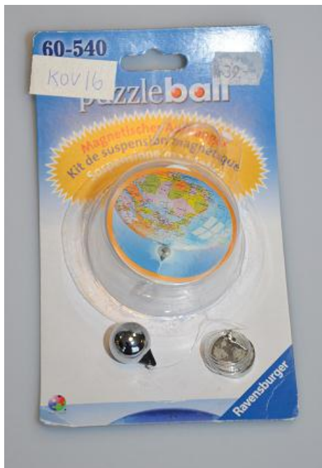
Bild 6. Magnetupphängning för pusselbollar. Superstarka magneter med ett uppmätt fluxvärde på 5488 \text{ kG}^2\text{mm}^2 . Saknar varningsmärkning. Produkten tillverkas inte längre. Återförsäljaren i Sverige har upphört med försäljningen.
