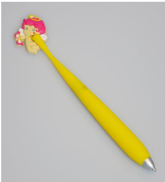
Bild 7. Penna med magnetfigur. Konsumentverket har bedömt pennan som en leksak med stöd av EU:s vägledning för gråzonsprodukter när det gäller ritmaterial 7 . Den lilla magnetfiguren lossnade vid provning. Magnetstyrkan uppmättes till 192 \text{ kG}^2\text{mm}^2 . Importören har upphört med försäljningen och återtagit produkten från återförsäljare.
