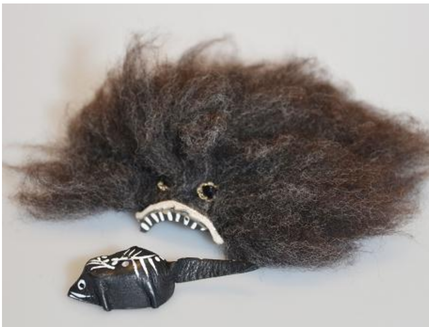
Bild 8. Leksak bestående av en magnetråtta och en lurvig magnetfigur. Leksaken klarade inte provningen. Magnetstyrkan på den del som gick in i smådelscy lindern uppmättes till 937 \text{ kG}^2\text{mm}^2 . Leksaken saknade CE-märke. Ärendehandläggning pågår
