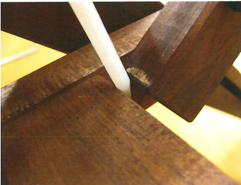
Figur 8 IKEA Äpplö, klämrisk uppstår när ryggstödet fälls bakåt, öppning < 4 mm
