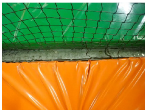
Bild 6. Lösa kantskydd som medför risk för barn att slå sig mot stålram eller komma ned med kroppen och fastna i huvud/hals mellan fjädrar.
